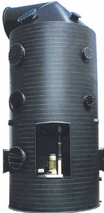
HDPE'den üretilmiş tank örneği
